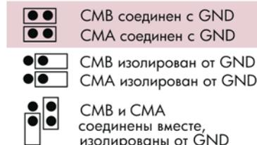
= Заводская установка перемычек
