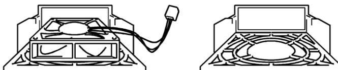
Крышка охлаждающего вентилятора
