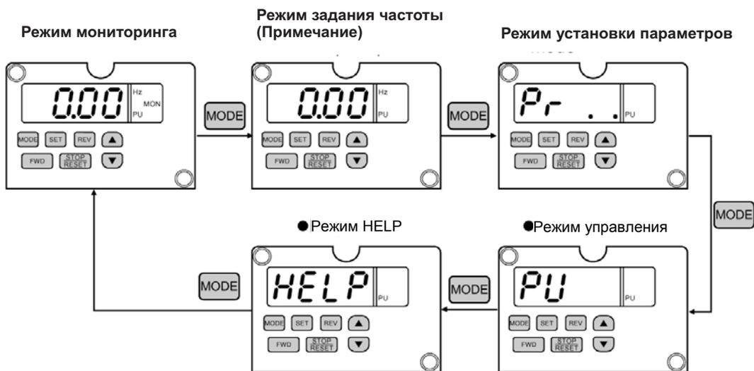
Примечание: Режим задания частоты доступен только в режиме управления с пульта PU.
