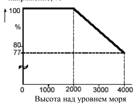
Рис.2-3. Влияние высоты установки привода
