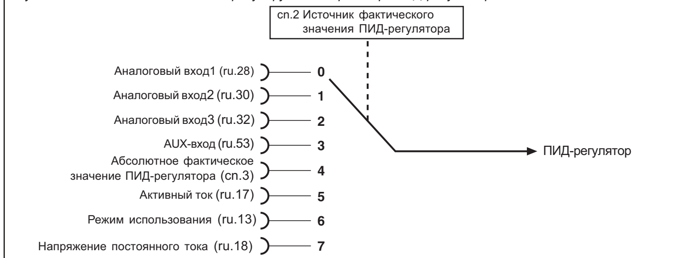
Рисунок 6.12.3 Фактическое значение регулируемого параметра ПИД-регулятора
