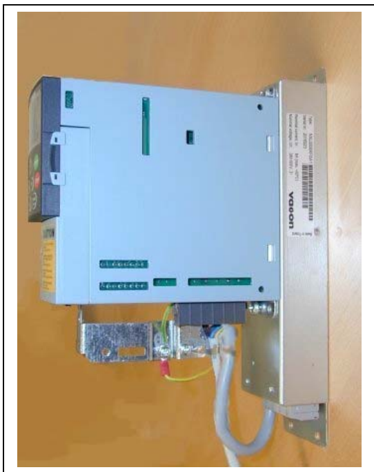
Рис. 6-9. MF2 с фильтром радиочастотных помех Рис. 6-10. Подключение кабелей при установке фильтра радиочастотных помех в Vacon NXL
