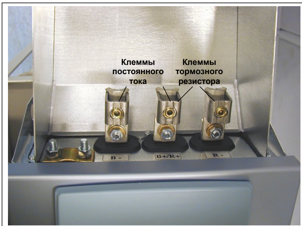
Рисунок 6-17. Клеммный модуль подключения тормозного резистора (сверху) FR8
