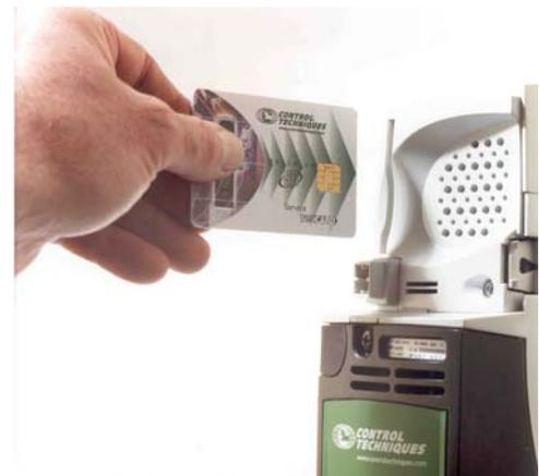
Рис.1. Установка в привод карты SMARTCARD.
