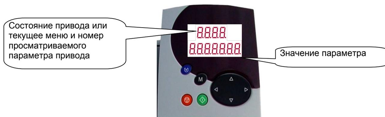
Рис. 7. Панель управления SM Keypad
