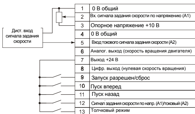
Рисунок 6.3 Клеммные соединения
