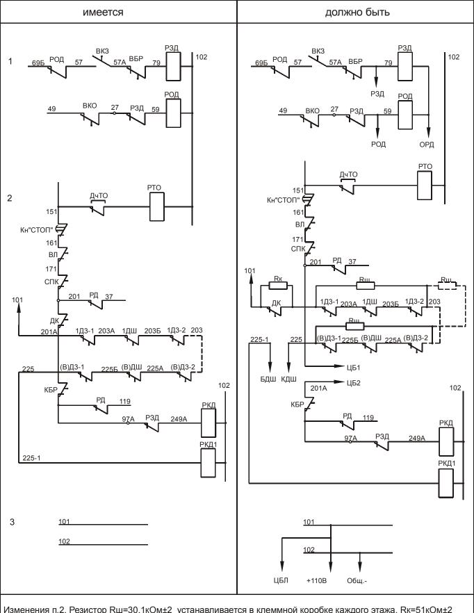
Изменения п.2. Резистор Rш=30,1кОм±2 устанавливается в клеммной коробке каждого этажа. Rк=51кОм±2 устанавливается в выключателе ДК.
