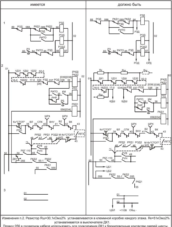
Провод 056 в подвесном кабеле использовать для подключения ДК1 к блокировочным контактам дверей шахты.
