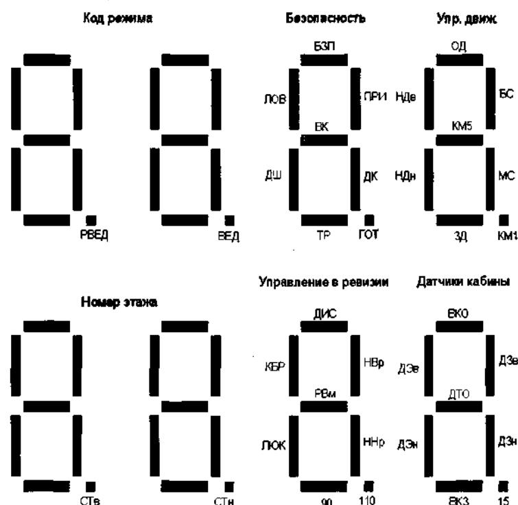
Рис 1 Отображение информации на индикаторах
