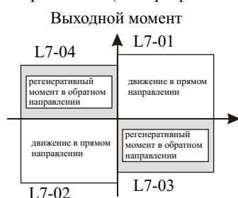
Рис. 5.46 Параметры ограничения момента
