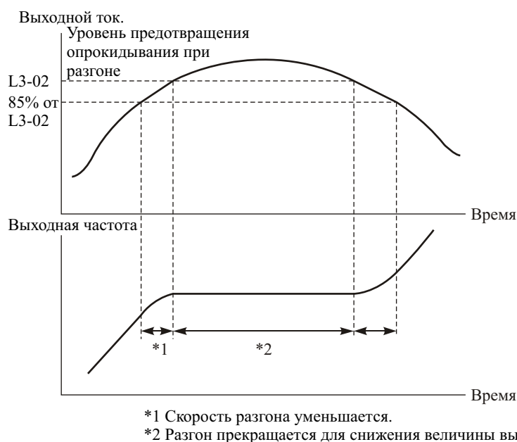
Рис. 5.38 Временная диаграмма предотвращения опрокидывания при разгоне.
