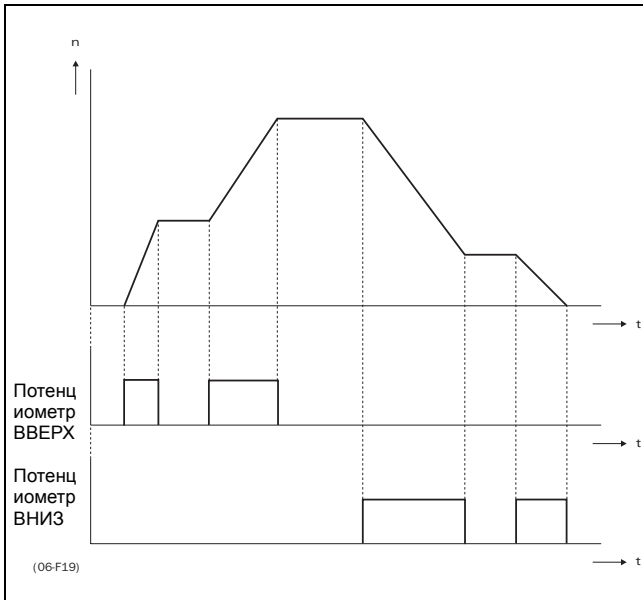
Рис. 64 Функция автоматического потенциометра.
