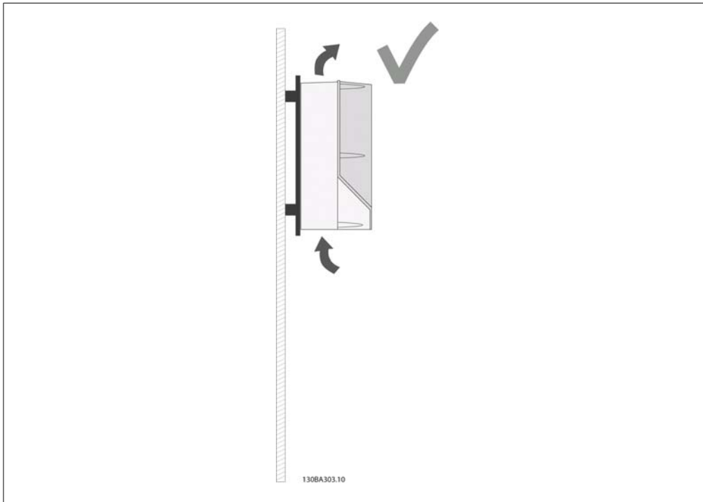
Рисунок 4.4: Если блок необходимо установить на небольшом расстоянии от стены, следует дополнительно заказать заднюю панель (см. код заказа, поз. 14-15). Блоки A2 и A3 имеют заднюю панель в качестве стандартной детали.
